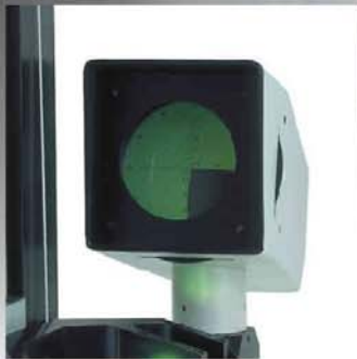
Präzise Vermessung durch hervorragende Optik mit 20-facher Vergrößerung. Drehbare Mattscheibe mit Vergleichsradien und Winklereinstellung.
