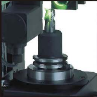
Präzisionsgelagerte Aufnahme-Spindel. 90° Indexierung (optional).
