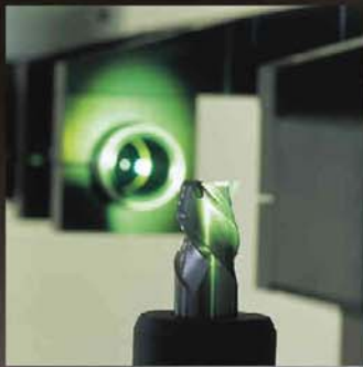
Berührungslose Vermessung der Werkzeugschneiden.
