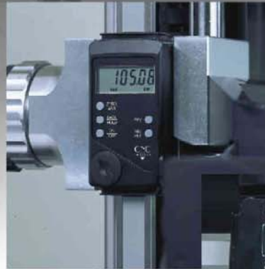
Bewährtes Meßsystem (Mitutoyo). Datenausgang in beiden Achsen.
