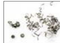
Beim Werkzeug von Wettbewerber X blieben die Späne aufgrund der instabilen Spankontrolle am Werkstück hängen.
