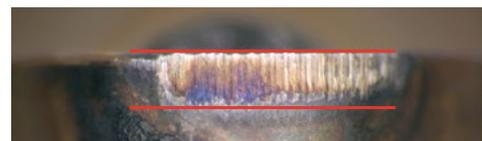
Schnittbedingungen: Vc = 300/400/500 m/min, ap = 0,5 mm, f = 0,2 mm/U, Nassbearbeitung Typ CNMG120408 Werkstück: 34CrMo4
