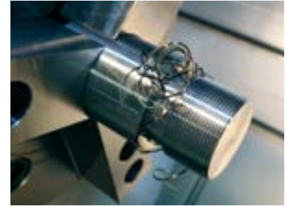
Beispiel für das Hängenbleiben von Spänen
