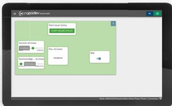
Auf dem **rd.HMI.7** werden die vorher im Prozesseditor definierten Elemente zur einfachen Übersicht und schnellen Bedienung angezeigt.
