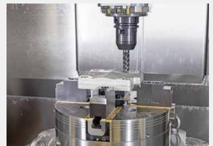
Mit dem Vier-Backen-Handspannfutter ROTA-M flex 2+2 vereint SCHUNK die Vorteile und Funktionen von Zwei-, Drei- und Vier-Backenfuttern in der Werkstückbearbeitung.
