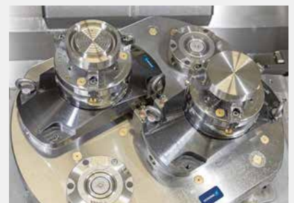
Auf der flexiblen Spannstation VERO-S lassen sich zwei Drehfutter ROTA-S plus 2.0 montieren und somit zwei verschiedene Werkstücke in einem Arbeitsgang in der Maschine bearbeiten.
