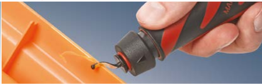
Entgratwerkzeug für das Außenentgraten von gebogenen Rohren.
